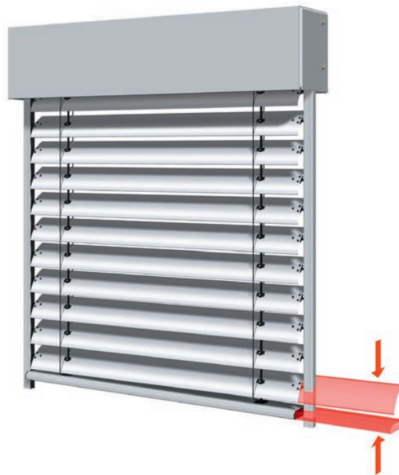
Bild 8: Lage der Unterschiene im abgefahrenen Zustand
